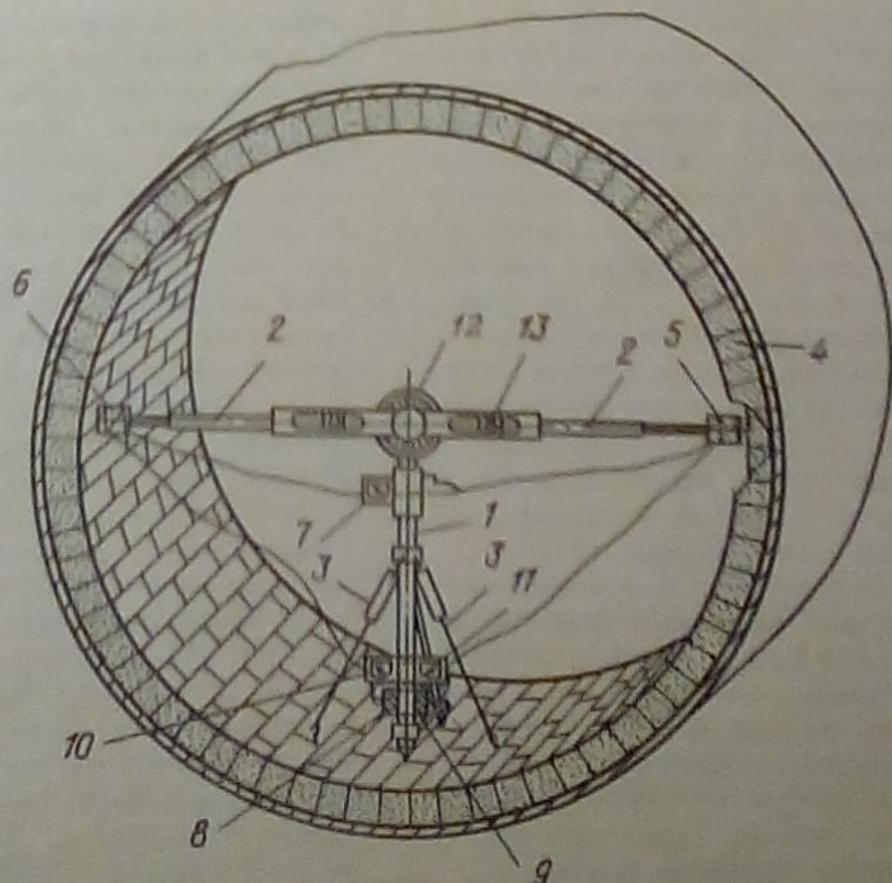
основании стойки 1 и на концах щупа 2 размещены индуктивные датчики 5, 6, 8, 9 зазора, подключенные к компараторам 7, 10 и 11, в которых обеспечивается сравнение их индуктивностей. С помощью тросовых оттяжек 3 стойку устанавливают строго по радиусу контролируемого сечения печи. Радиальное положение стойки 1 определяют по равенству регулируемых в процессе измерения длин плеч щупа 2 при условии равенства выходных сигналов индуктив-
