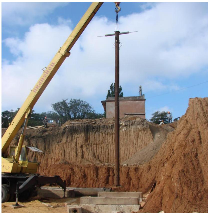
*Рисунок 6 – Общий вид штампа для испытаний ракушечника на продавливания*
