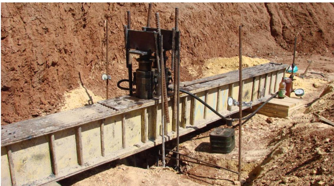
Рисунок 5 – Нагрузки сваи выдергивающими нагрузками
