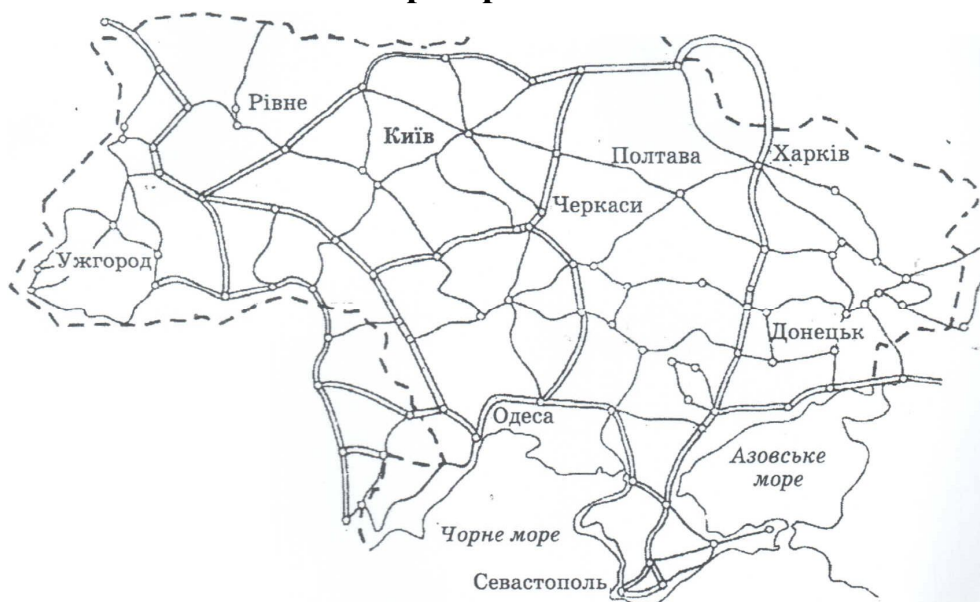
Рис. 7.2.5 Державна висотна основа України: ----- лінії нівелювання I класу; - - - лінії нівелювання II класу
