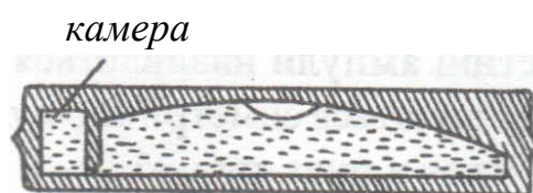
Рис.3.3.3 Рівень з запасною камерою
