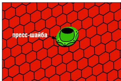
Рис. 3.92. На нижнюю поверхность проходного элемента наносят силикон
