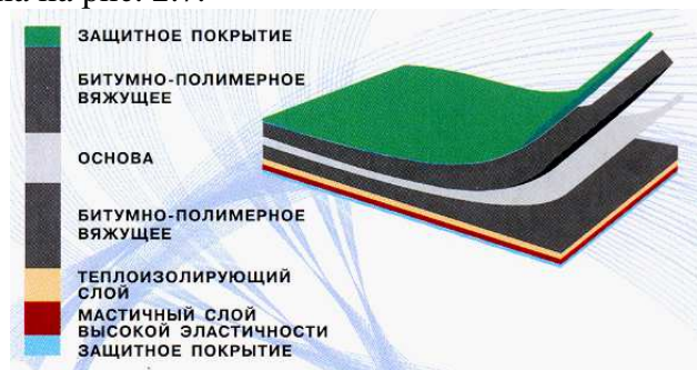
Рис. 2.7. Структура Физизол-Супер и Физизол-Маст
