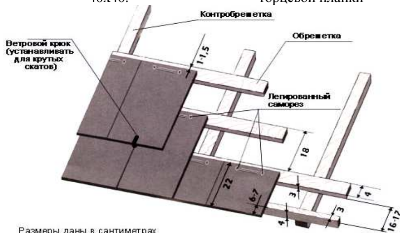
Рис. 3.49. Схема монтажа плиток формата 25x40.
