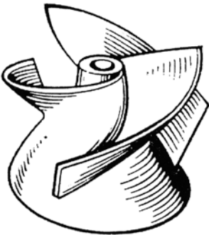
Мал. 1.10. Діагональне робоче колесо відкритого типу (без переднього диску). Загальний вид.
