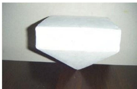
Рис. 1. Образец фигурного элемента мощения с пирамидальным основанием
