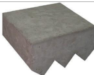
Рис. 2. Опытный образец фигурного элемента мощения с ребристым основанием
