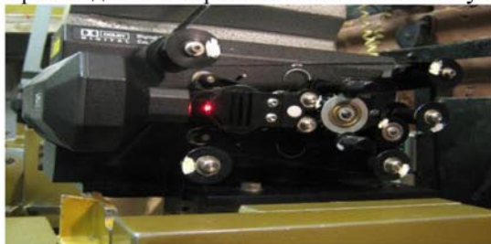
Рис.16. Звукоблок кинопроектора для чтения оптической фонограммы
