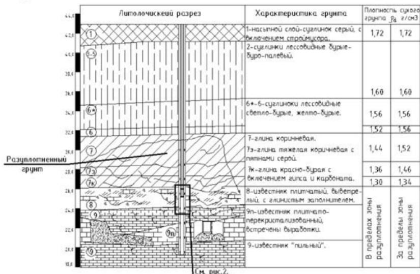
Рис.1. Инженерно-геологический разрез
