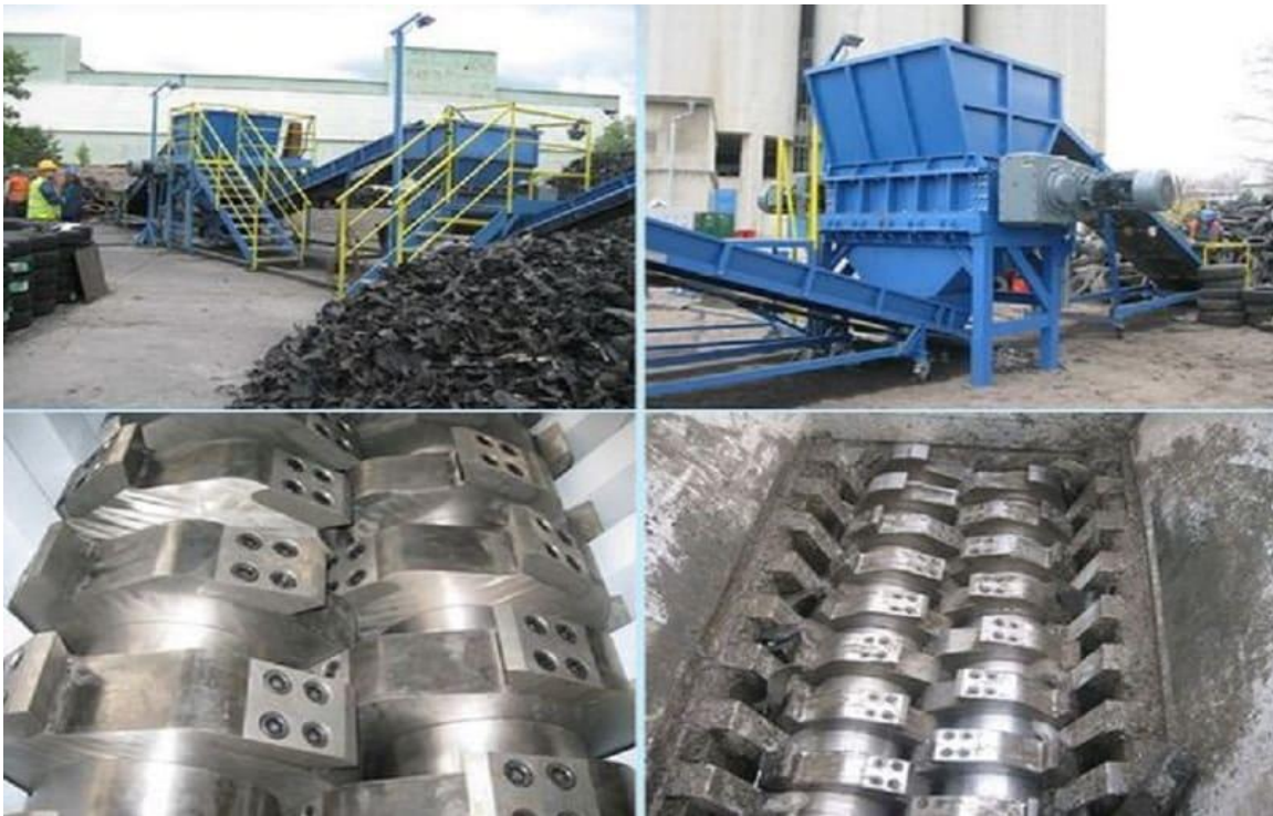
Рис. 1. Процес виготовлення гумової крихти шляхом подрібнення покришок
