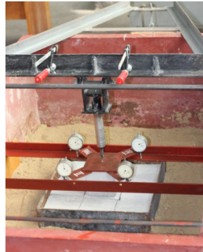
Рис. 4. Опытно-производственный стенд для исследования покрытий из ФЭМ с измененной геометрической формой основания
