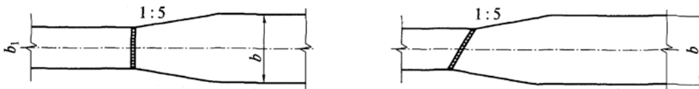
Рис. 4.13. Зварне стикове з'єднання при різній ширині з'єднувальних елементів
