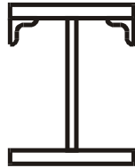
Рис. 7.3. Стиснутий пояс двотаврового перерізу з обрамляючими ребрами
