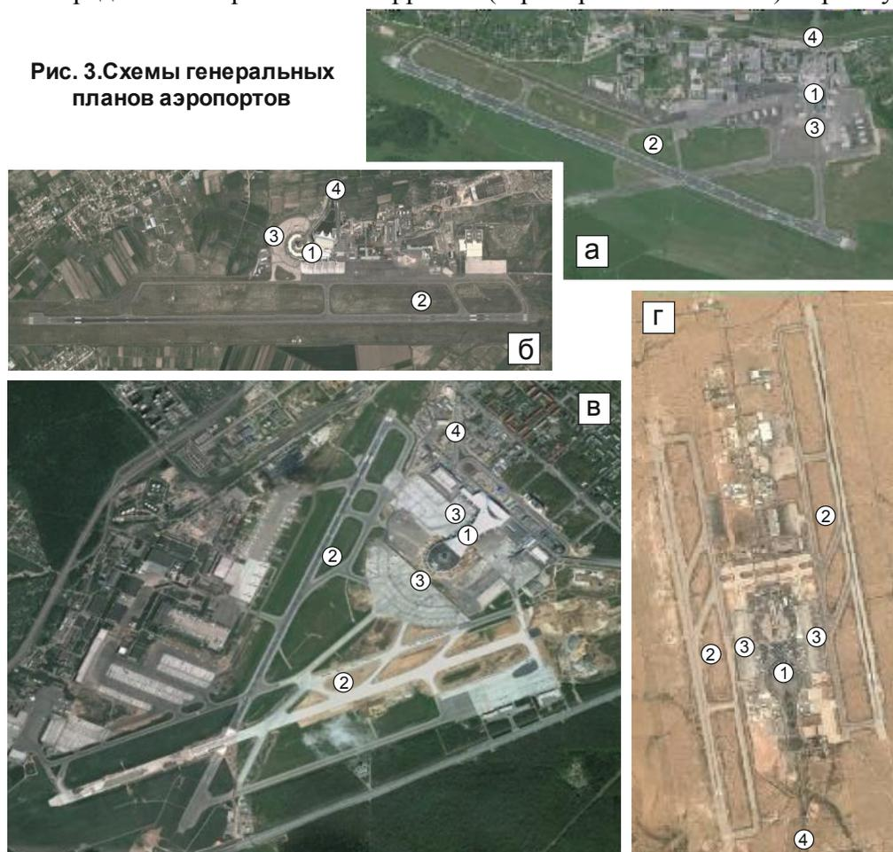
Рис. 3. а, б - с одной взлетно-посадочной полосой (Вильнюс, Литва; Звартоц, Ереван, Армения); в - с пересекающимися полосами (Внуково, Москва, Россия); г - с параллельными полосами (Амман, Иордания): 1 - пассажирский аэровокзальный комплекс; 2 - взлетно-посадочные полосы; 3 - перрон; 4 - подъездная автодорога.
