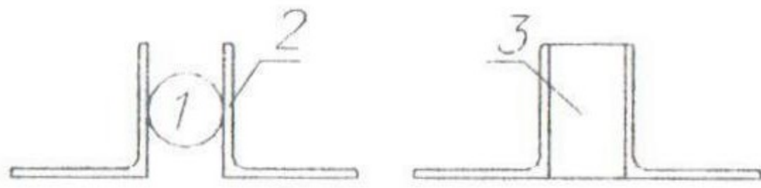
Рис. 3. Сечение конструкции анкерной тяги из двух уголков 180 × 12 мм:
