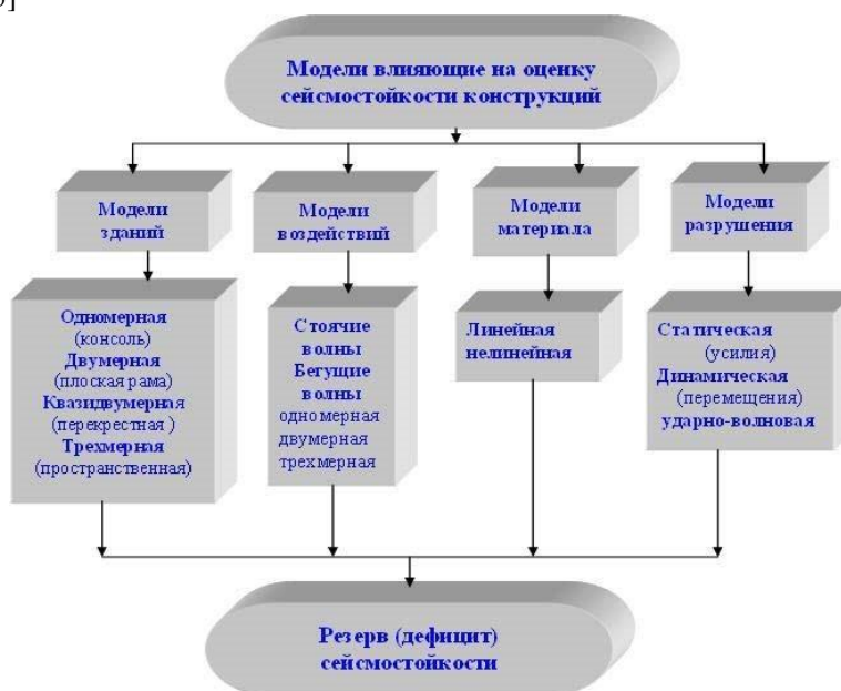
Рис. 1. Модели, влияющие на оценку сейсмостойкости конструкций
