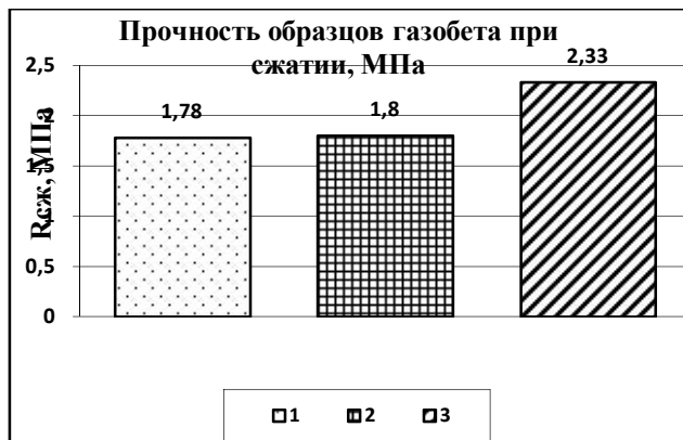
Рис. 4. Изменение предела прочности при сжатии газобетона в возрасте 28 суток: 1 – контрольные образцы газобетона, 2 – модифицированные образцы газобетона микрофиброй 900 г/м 3 ; 3 – модифицированные образцы газобетона микрофиброй и 500 г/м 3 .
