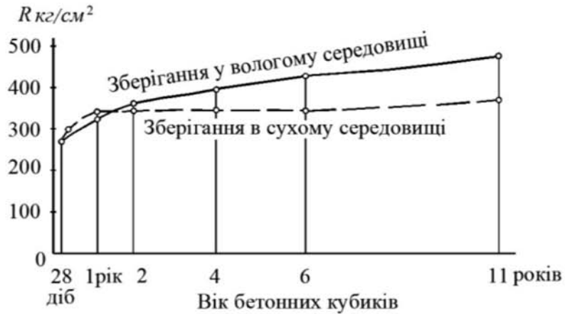
Рис. 1. Наростання міцності бетону в часі
