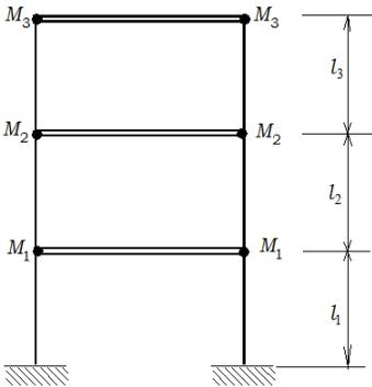
препятствуют повороту в плоскости чертежа тех сечений колонны, в которых находятся сосредоточенные массы, но не препятствуют перемещению этих сосредоточенных масс (рис. 2).
