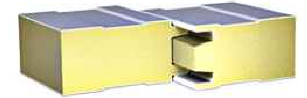
Подвійні шип-паз кінчної форми при товщині панелі 60-180 мм
