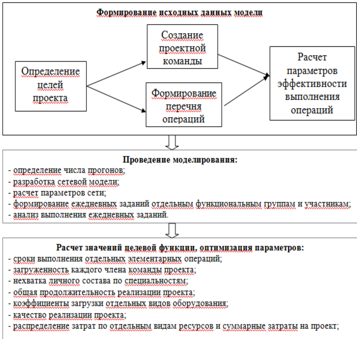
Рис.1. Схема алгоритма процесса симуляционного моделирования
