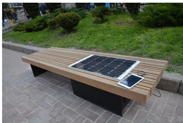
Мал. 2.9. Лавка з вбудованими сонячними батареями в Києві
