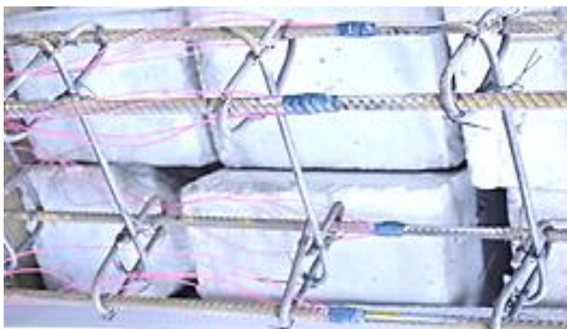
Рис. 4. Наклеювання тензорезисторів на арматуру
