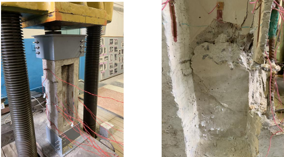
Рис. 5. Випробування дослідних зразків: а – процес навантаження; б – руйнування колон
