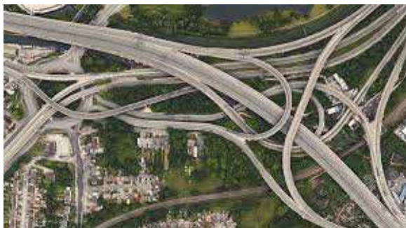
Рис.3. Грейвелли Хилл — шестиуровневая развязка, открытая в Англии в 1972 г. и прозванная за свою путанность «спагетти», что стало именем нарицательным для сложных стековых развязок.
