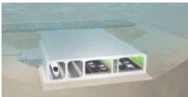
Рис. 5. Разрез тоннеля в проливе Фёрман-Бельт
