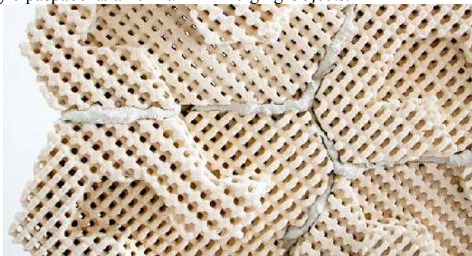
Рис. 3. Новый стройматериал – кирпич с охлаждением.
