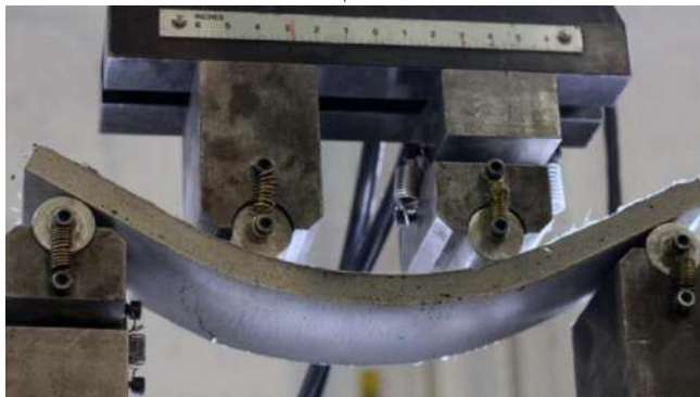
Рис. 2. Эластичный самовосстанавливающийся бетон.
