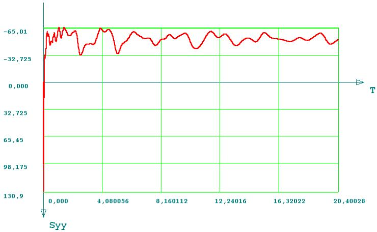
Рис. 6. Эпюра напряжений  $\sigma_{22}$  в точке А от сосредоточенной динамической нагрузки  $Q_2 = 45$  т.
