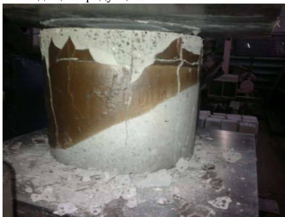
Рис. 1 . Испытание на кольцевую прочность
